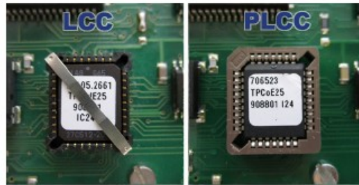
Obr. 2a a 2b: Paměťové jednotky EPROM na ovládacích deskách
